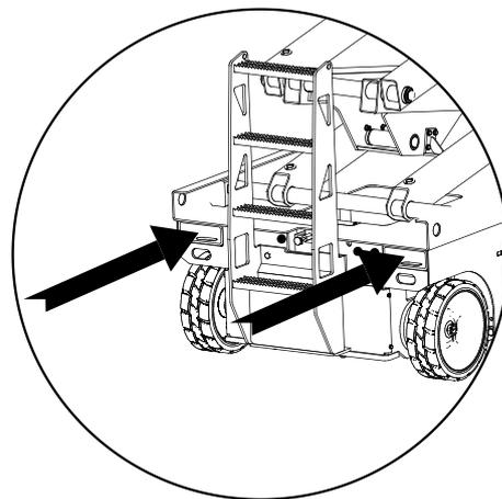
Вышка также может быть поднята при помощи траверсы и четырех тросов или цепей равной длины, способных выдержать полный вес вышки.
