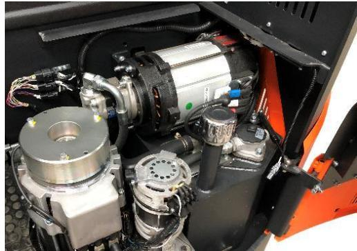
Заменяйте гидравлическое масло всякий раз при ухудшении рабочих характеристик гидроузла, а также ежесезонно, в случае эксплуатации в среде с резкими перепадами рабочих температур. Процедура должна проводиться специально обученным персоналом, когда электрический штабелер установлен неподвижно на ровной поверхности с опущенными вилами. Замену масла рекомендуется производить специалистами сервисного центра регионального представительства NOBLELIFT INTELLIGENT или его уполномоченными дилерами.
