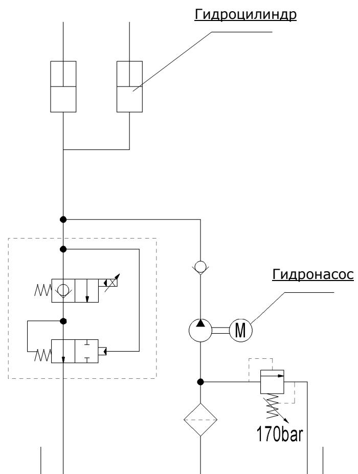
Рис. 23: Гидравлическая схема
