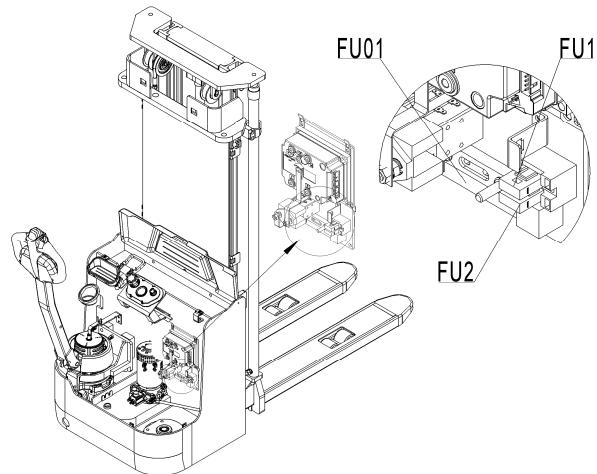
Рис. 21: Расположение предохранителей
